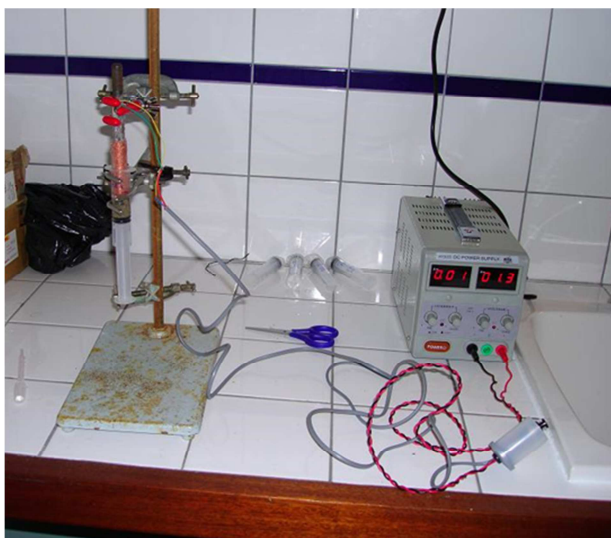
Fig. I.11 : mesure de la stabilité du sédiment avec le MagPI. a. système de mesure ; b. attraction des particules ferromagnétiques par l'électro-aimant.
