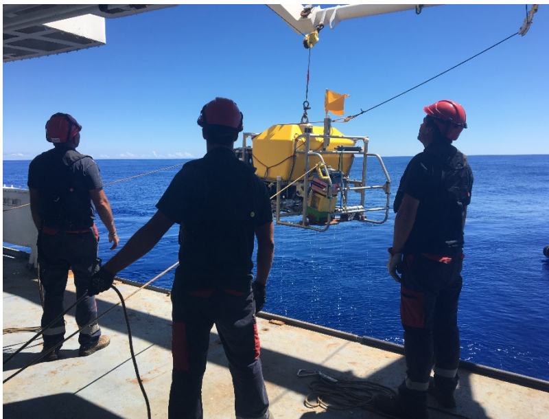
Récupération de la cellule de récolte PERISCOP, fixée sur l'ascenseur, lors de la mission TRANSECT. La cellule contient un échantillonnage de crevettes Rimicaris exoculata maintenues à la pression du fond, ici 23 MPa (site Rainbow, 2300 m de profondeur). © B. Shillito.
