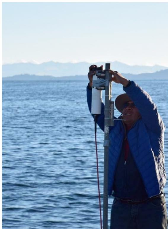
*Spectroradiomètre Biospherical de radiations UV-
