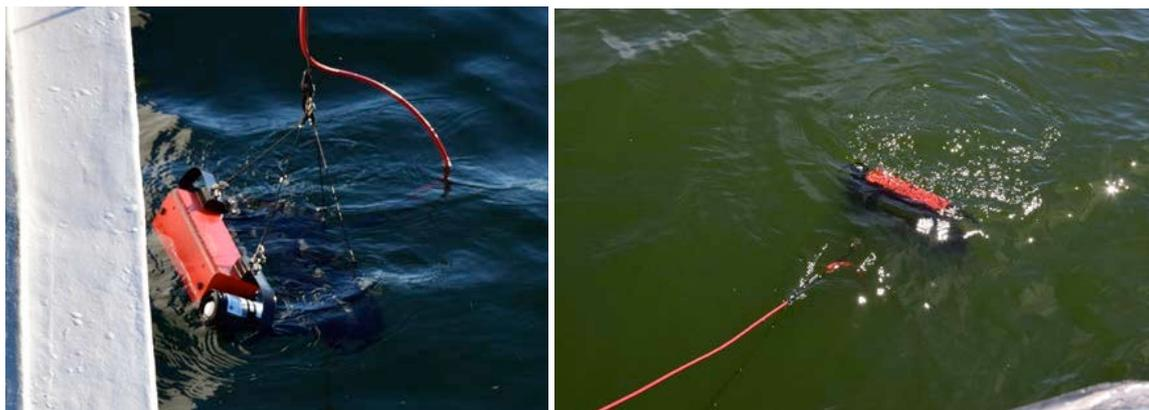
*Sonde spectroradiométrique immergeable Biospherical C-OPS pour la mesure de l'atténuation verticale de 8 longueurs d'onde entre UV-B, UV-A et PAR (Photo J. Février, 2018)*
