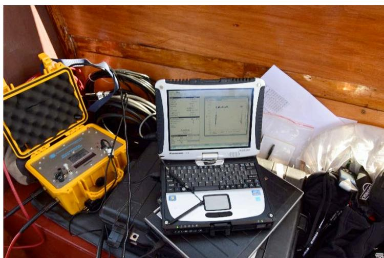
*Centrale d'alimentation et d'acquisition Deckbox Biospherical (boîte jaune) et PC portable Panasonic Toughbook CF-19 pour le stockage et l'analyse des données d'atténuation verticale des radiations solaire UV-B, UV-A et PAR (Photo J. Février, 2018)*
