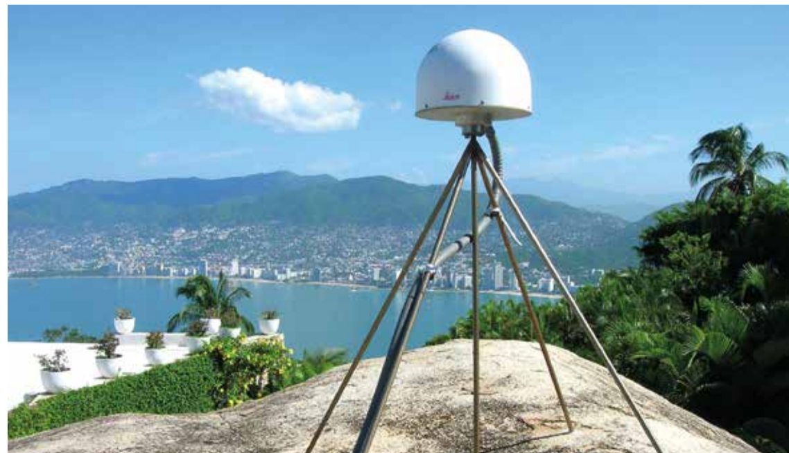
Station GPS permanente placée au cœur de la lacune sismique de Guerrero, surplombant la baie d'Acapulco.
