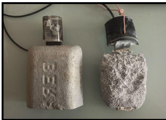
Figure 19 : Comparaison entre une anode galvanique neuve (à gauche) et corrodée (à droite).
