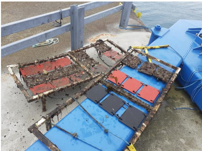
Structures immergées avec les revêtements testés dans le projet BIOSTEM. Revêtement noir : epoxy, revêtement rouge, fluoropolymère. Eprouvettes colonisées à 5 et 8 mois. Copyright – tous droits réservés
