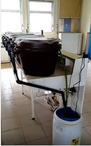
Ecole Supérieure d'Agronomie (ESA) : Structure de conditionnement alimentaire en circuit fermé comprenant 4 unités de 3 bassins de 60L. Etang de la pisciculture du Béliér assurant le grossissement des espèces Oreochromis niloticus et Heterotis niloticus – Yamoussoukro – Côte d'Ivoire.
