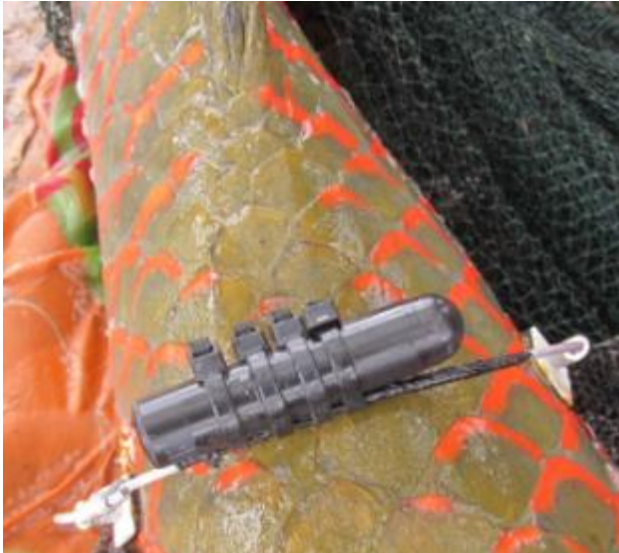
Figure 38 : A. gigas équipé d'un émetteur ultrasonique (16 x 80 mm, 76 KHz) de 35 g (MM-M-16-50 PM, LOTEK Inc.) (a) et hydrophone (WHS 3250D, LOTEK Inc.) fixé sur un poteau métallique et immergé à la périphérie de l'étang expérimental (b).
