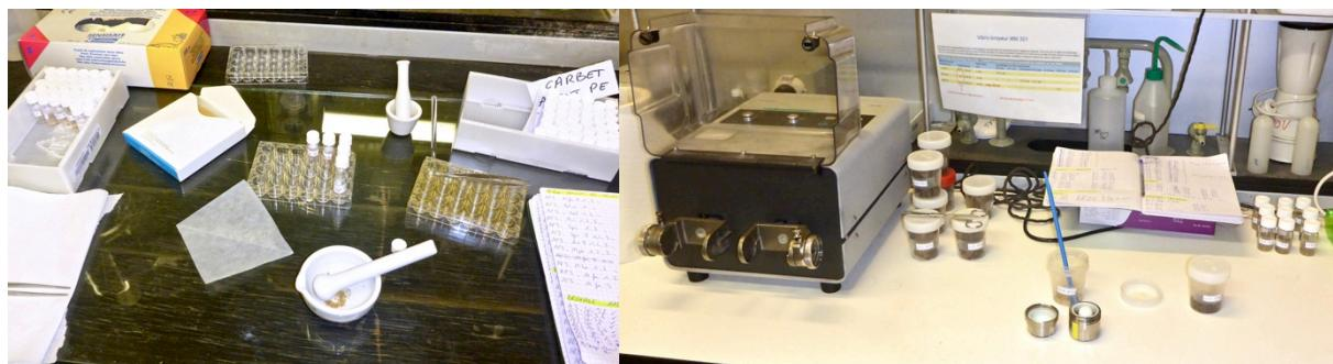
Figure A1.1 : Broyage des échantillons manuellement (gauche) ou mécaniquement (droite).
