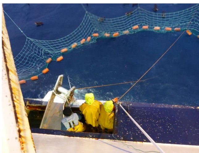
Figure 5.1 Vue du bunker latéral sur le « Cap Horn » et le rideau de Brickle. Source : Nicolas Guillon
