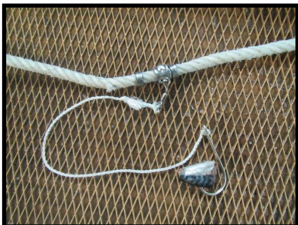
Figure 3.6 Avançon et hameçon appâté avec du maquereau fixés sur la ligne mère. Source : Luc Fargier
