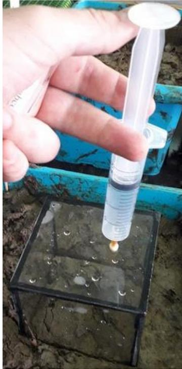
Figure 1: Photo d'un prélèvement de gaz dans une chambre de mesure avec une seringue hypodermique
